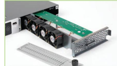
O nShield Connect inclui uma alimentação dupla de hot swap, bandejas substituíveis em campo e trilhos de deslizamento opcionais para a montagem em rack.
